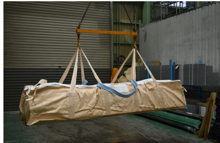
上記のような治具を使えば、より安定して吊ることが出来ます。
